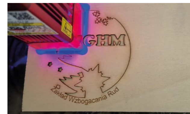
Rysunek 2 Wycinanie wzoru za pomocą lasera.
