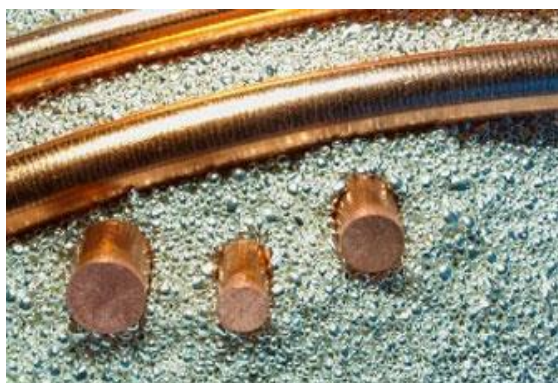
Obraz 3. Drut z miedzi beztlennej zawierającej srebro
