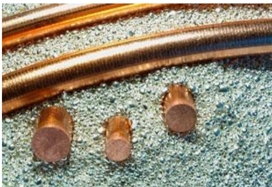
Obraz 3. Drut z miedzi beztlenowej zawierającej srebro
