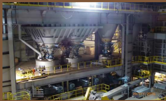
Układ ładunku wsadu do Pieca Zawieszinowego
