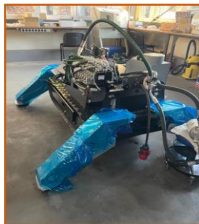
Prototyp do czyszczenia kotła w hucie miedzi
